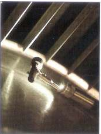
アリゲーターツールにより落下したボルトを回収
