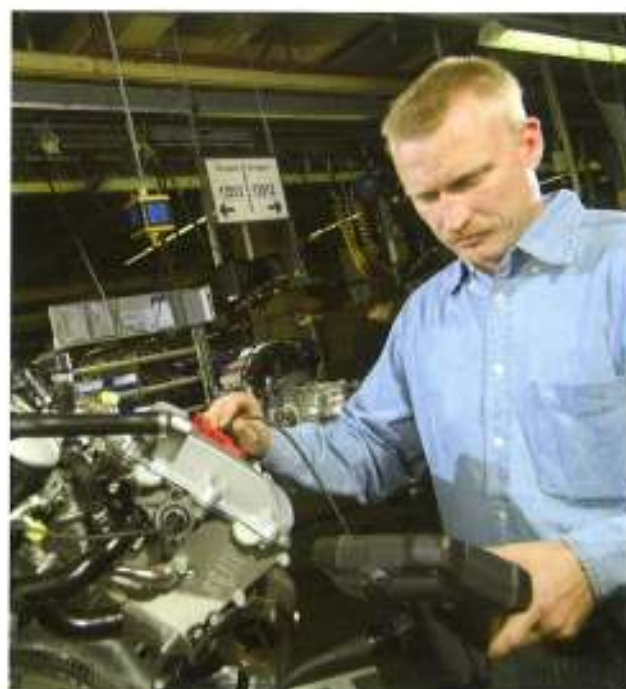
スパークプラグのポートからバルブシートの検査
