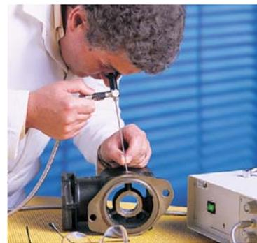
ミニリジッドスコープによるエアブレイクコンプレッサーの検査
