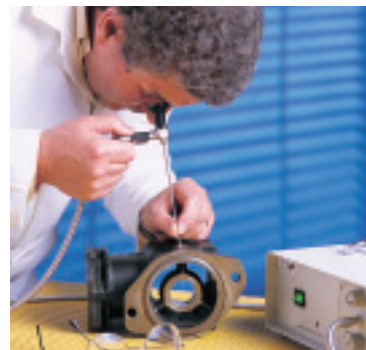
ミニリジッドスコープによるエアブレイキコンプレッサーの検査
