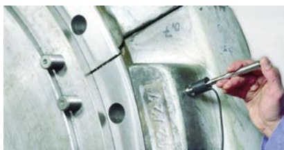
鍛造品の硬さ測定
