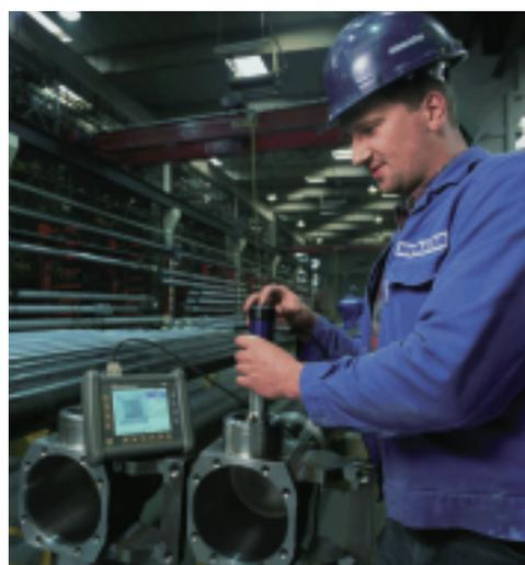
図11：現場でのTIV法ポータブル硬さ計の使用例
