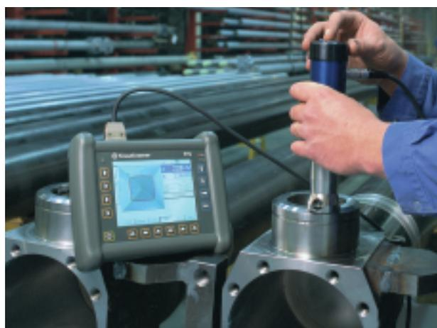
図4：TIV（くぼみ直視型）法による、組立前の最終工程検査として実施
