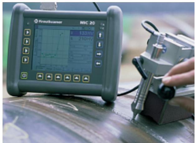
図1：溶接部の熱影響部（HAZ）の硬さ試験。
