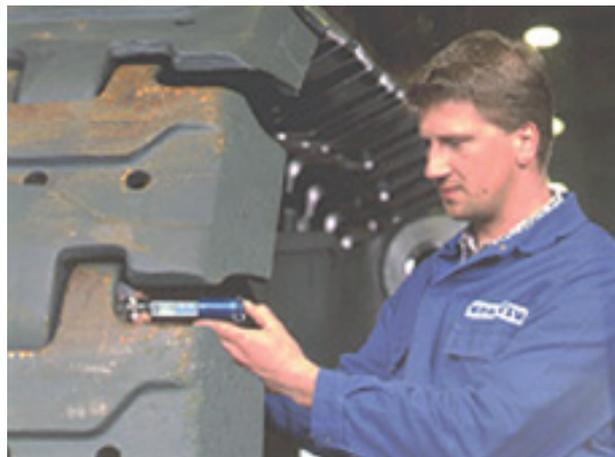
図3：DynaPOCKETによる、露天掘り用掘削機のキャタピラークさびの硬さ試験
