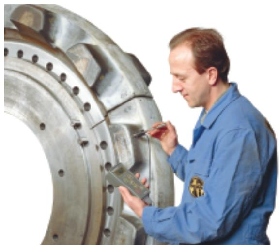
図2：リバウンド式ポータブル硬さ計DynaMICにより、油圧式大型掘削機の駆動ホイールの硬さ試験
